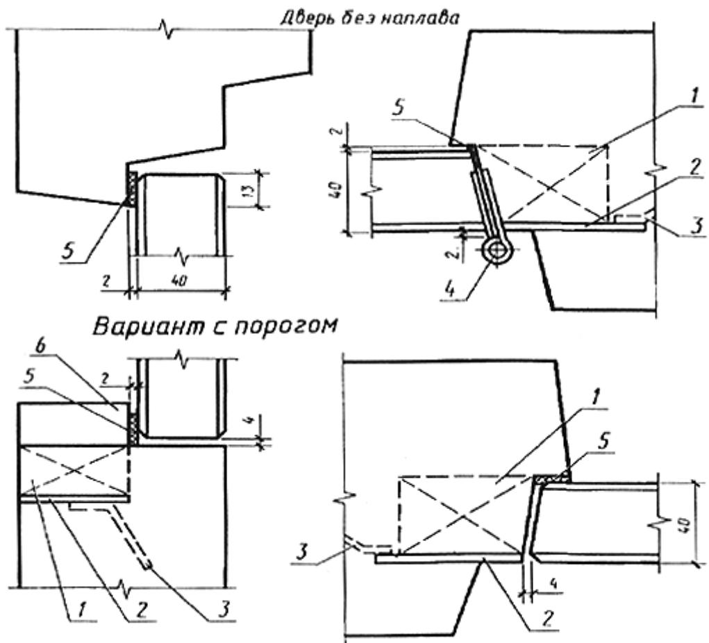
1 - деревянная пробка; 2 - стальная пластина; 3 - анкер; 4 - накладная петля; 5 - уплотняющая прокладка; 6 - деревянный порог
