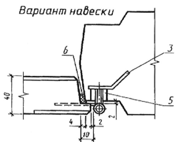
1 - деревянная пробка; 2 - стальная пластина; 3 - анкер; 4 врезная петля; 5 - винтовая карта петли с гайкой; 6 - уплотняющая прокладка
