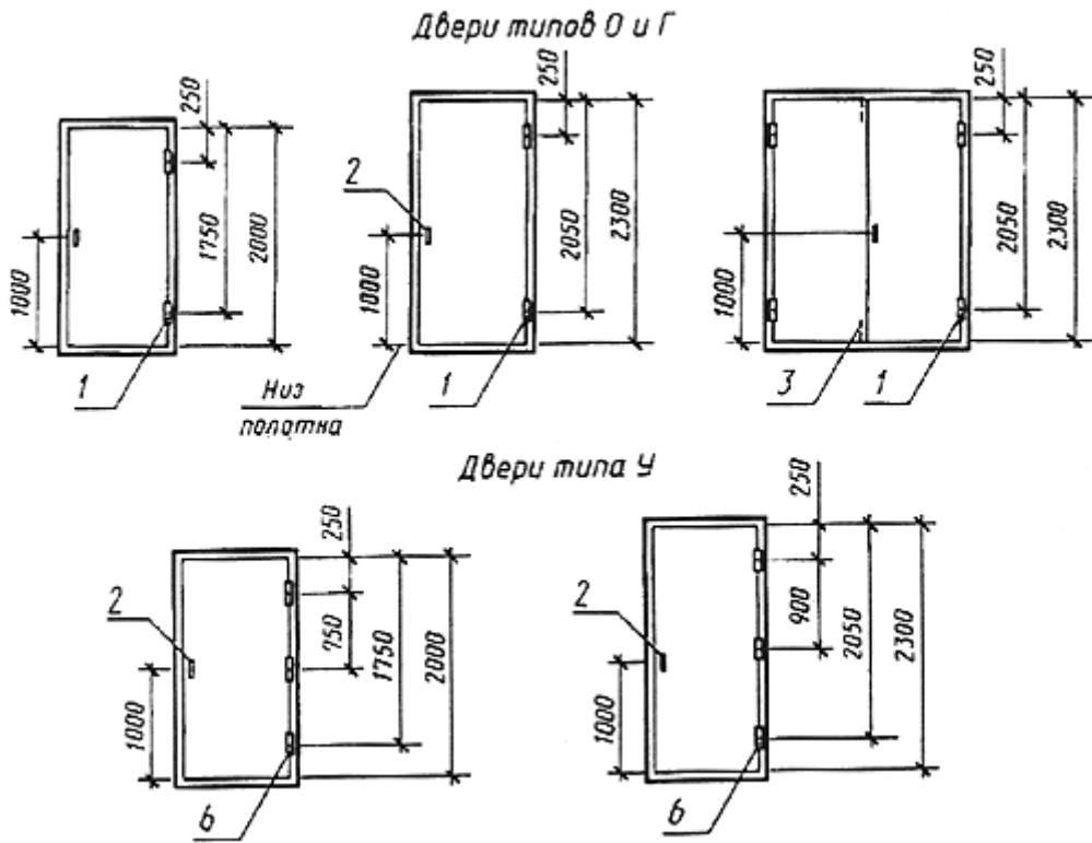
1 - петли ПН1-110, ПН1-85, ПН2-110, ПН2-85, ПН3-110, ПН4; 2 ручки РС100, РС140, РК1, РК2, замки и защелки; 3 - задвижки ЗТ; 4 петли ПВ1-100, ПВ2-125 или винтовые и накладные петли; изготавляемые по специальным ТУ; 5 - замки ЗВ7А, ЗВ4; 6 - петли ПН1-130, ПН1-150, ПН2-130, ПН3-130, ПН3-150.
