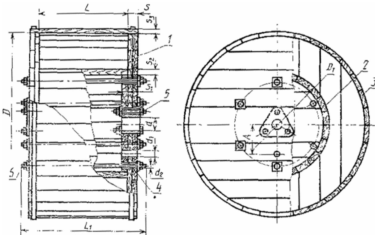
1 - щека; 2 - шейка; 3 - обшивка; 4 - круг шейки, 5 - втулка, 6 - шпилька
