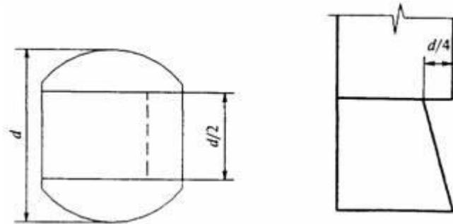
Тип соединения симметричным трапециевидным шипом (глухим «сковороднем»)
