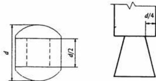
Тип соединения прямоугольным трапецевидным шипом (открытым «полусковороднем»)
