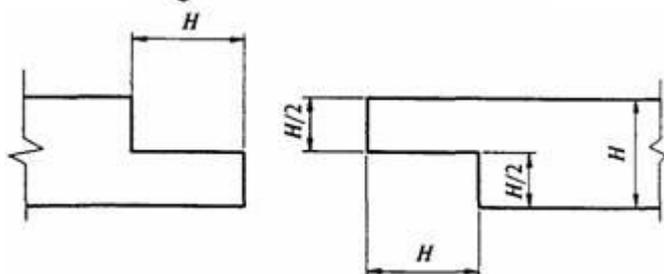
Тип продольного соединения «на косой замок»
